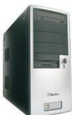
**Servidor** Pode ser tipo gabinete, ou 19" (tipo Rack). Deve ser considerada a profundidade para a escolha do Rack. Dividir a altura total em mm por 44,45 para saber o total de U's que ocupa no Rack. Mais utilizado no Gabinete Rack 19".
