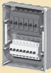
Laterais com suporte para instalação de barras de neutro ou terra. Acompanha barra neutro ou terra (ver tabela). Entrada para eletrodutos de 1/2" e 3/4" no modelo de embutir. No modelo de sobrepôr 1/2", 3/4" e 1" e canaletas 20x10 mm.
