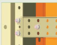
Fixação diretamente nos perfis laterais através de parafusos M8
