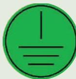
Etiqueta de identificação do ponto de aterramento, colada na placa de montagem, ao lado do parafuso de aterramento
