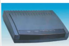
**Switch / HUB** Realiza a interligação entre os computadores. O Switch possui a mesma utilização que o HUB, porém a transmissão e recepção de dados é bem maior, pois ele guarda os endereços das máquinas. Ocupa 1U e necessita bandeja fixa para instalação.
