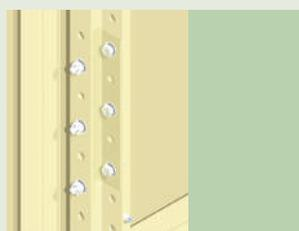
Detalhe de montagem da conexão de acoplamento entre as colunas de dois painéis
