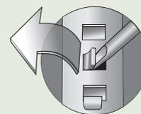
Bloqueio mediante sistema FAS com chave de fenda
