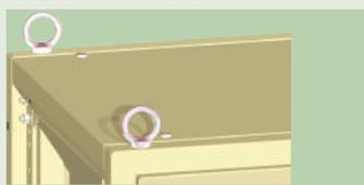
Instalação das argolas de içamento, na furação existente nas colunas
