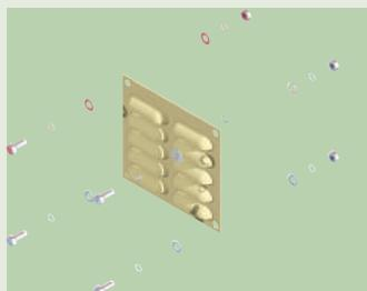
Detalhe de montagem da flange de ventilação com parafusos e porcas
